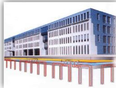
Les températures accessibles sont inférieures à 30°C, il s'agit de géothermie **très basse énergie** faisant appel à des pompes à chaleur.
